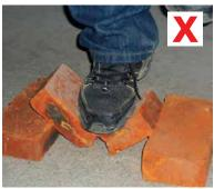
要使用烧制足够的砖,这样的砖不易破碎或裂。Use FULLY FIRED BRICKS that don't crumble or break.
