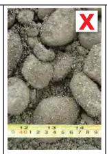
配置混凝土时不能使用 连沙石。
