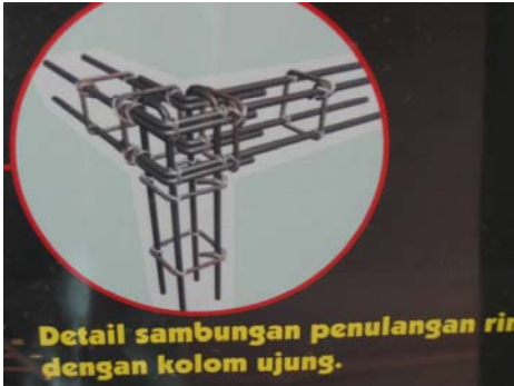
Gambar 11. Detil sambungan sloof dan ring balok dalam poster-poster yang dibagikan oleh CEEDEDS, UII, IMG_6618
